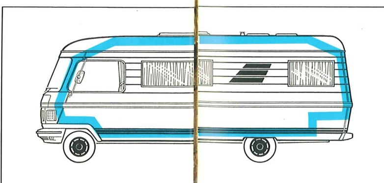
Knautschzonen im Front- und Heckbereich des Hymermobils.
