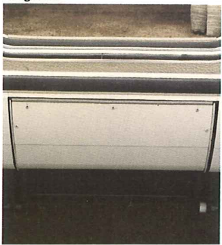
Trittstufe, in der Seitenschürze integriert.
